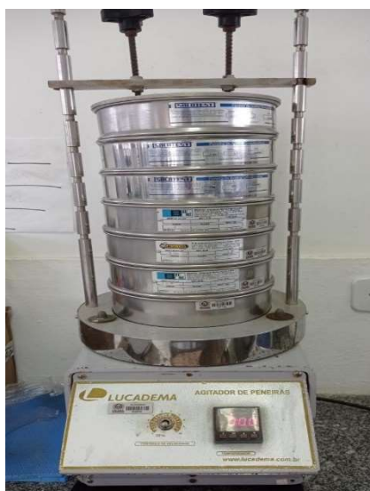
Figura 2: Peneira utilizada para a granulometria do material.
