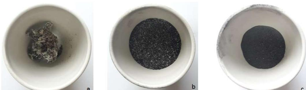
**Figura 2:** são ilustrados os resíduos, escória de fundição, areia de fundição e pó de ferro obtidos a partir da empresa A.
